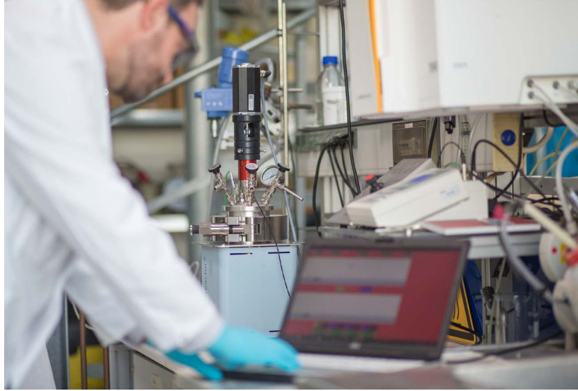
Hochdruck-Aufschlussreaktor für die Vorbehandlung von Biomassen im Technikum des PFI
